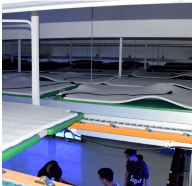
节能灯老化线是节能灯生产的专门的生产设备，节能灯老化线通过模拟各种使用环境来测试节能灯产品的性能和使用寿命，从而提升这些产品的质量！节能灯行业的发展符合节能减排的政策要求，另一方面可以为我们节省电费开支，所以节能灯产品很受消费者的喜欢，随着节能灯产业的发展，节能灯老化线的需求也日益增长。节能灯老化线功能特点：节能灯老化线是节能灯生产的专门的生产设备，专门的于节能灯整灯自动老化。通过对节能灯整灯的高中低电压、高温高压、冲击电压、模拟市电波动电压等电压的老练，观察节能灯整灯是否能够承受这些电压的冲击，从而提升这些产品的质量！随着各种节能灯产品的面世，对老化线的要求也在发生不断的变化，这就要求老化线生产商要不断了解市场的需求，加强创新和技术研发，生产出更多高质量，高精度的老化线产品，充分满足企业的各种测试需求，提高节能灯产品的质量。
