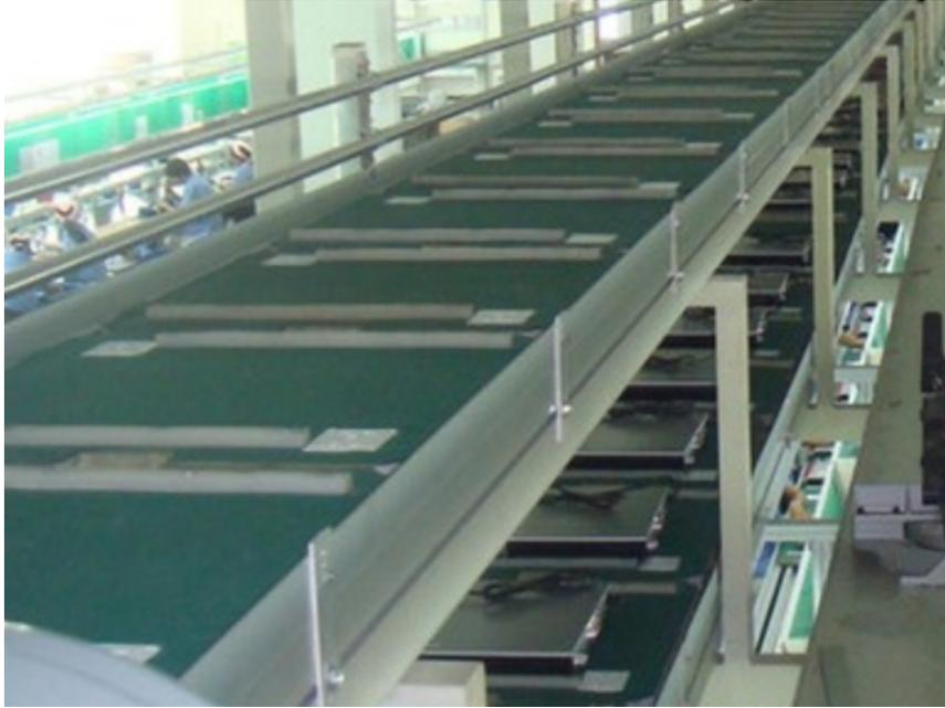
老化线要避免一些抽检风险在线检测，有效控制各项光、色、电性能指标，有效保证产品质量；节约人力成本自动化程度高，整套系统由1人上灯1人下灯，减少搬运强度；通用性强适用于路灯/面板灯：一对一检测在线检测每个灯的光、色、电参数，自动保存数据并生成测试报表，自动区分良品和不良品，系统会按照其位置在电脑界面上进行编号，每个产品用LED颜色变化报警提示其检测结果，直观便捷，有效提高生产品质和生产效率数据存储功能自动记录并生成实时测试报表，按位保存，调取查阅方便；测试数据可以保存，可以发到网上去供国内外客户查看，提高客户对公司产品质量的信心提升公司形象，从而增强公司在同行业中的竞争力老化线按老化产品类别分为：电子线路板老化线、照明电器老化线、电器产品老化线等。南昌多层老化线
